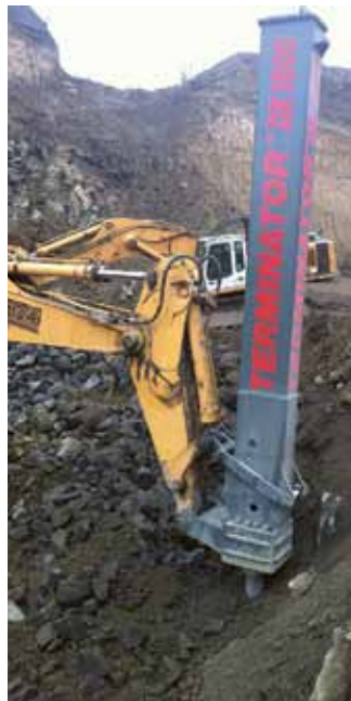
Mit Hammer und Meißel: Der Fallgewichtshammer Terminator DX1800 von der neuseeländischen Firma Rocktec International Ltd. entwickelt eine enorm hohe Schlagenergie von 180 000 kJ.
